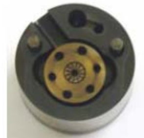
รูปแสดงภาพการเกิด IDID ภายในหัวฉีดและบริเวณ Control valve
