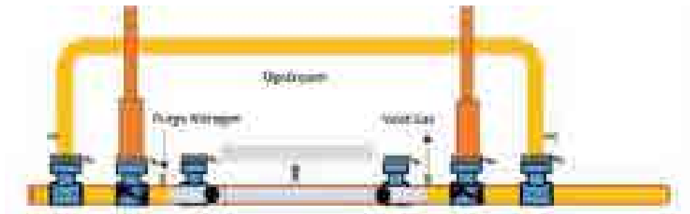
รูปที่ 5 การติดตั้ง Vent Gas, Purge Nitrogen และตัดท่อ
