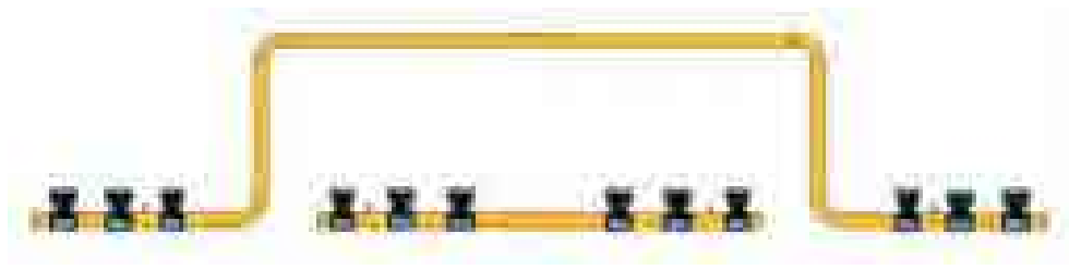
รูปที่ 9 Completion plug และปิดด้วย Blind flange
