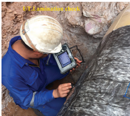
รูปที่ 2.1 แสดงตำแหน่งการวัดค่าความหนาเดิมด้วยวิธี UT
