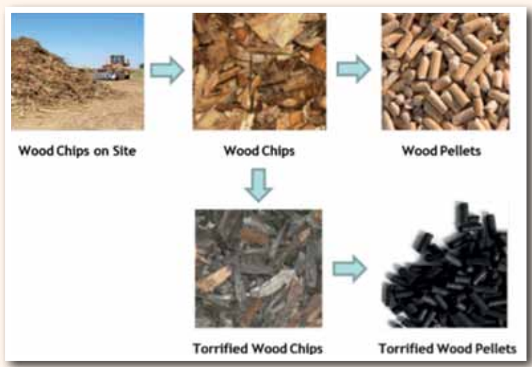
ชีวมวลที่ผ่านกระบวนการ Torrefaction หรือ Densification
