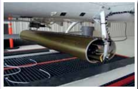
การติดตั้งเครื่องตรวจจับก๊าซธรรมชาติในอากาศยานแบบ Laser Methane Sensor เข้ากับเฮลิคอปเตอร์
