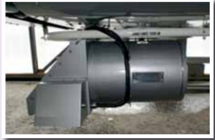
การติดตั้งเครื่องตรวจจับก๊าซธรรมชาติในอากาศยานแบบ Infrared Camera เข้ากับเฮลิคอปเตอร์
